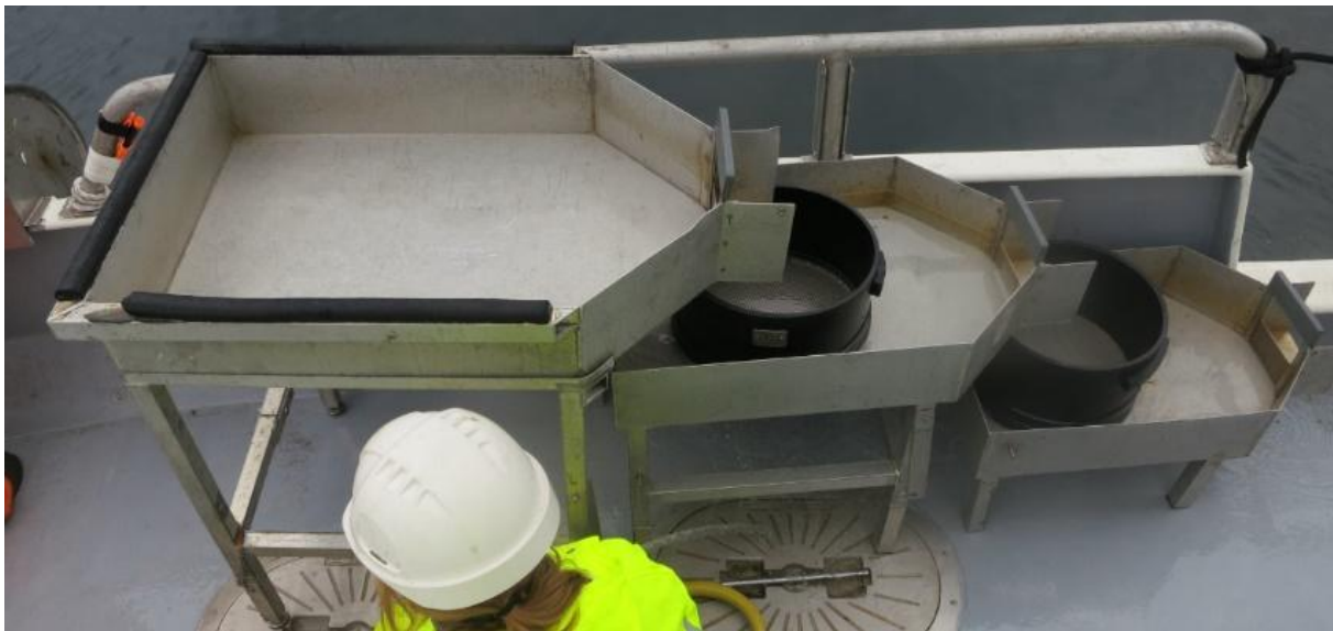
Figur 4. Sediment i godkjente prøver ble skylt med vann og siktet på et vaskebord, gjennom sikter med 5 mm og 1 mm hull.
