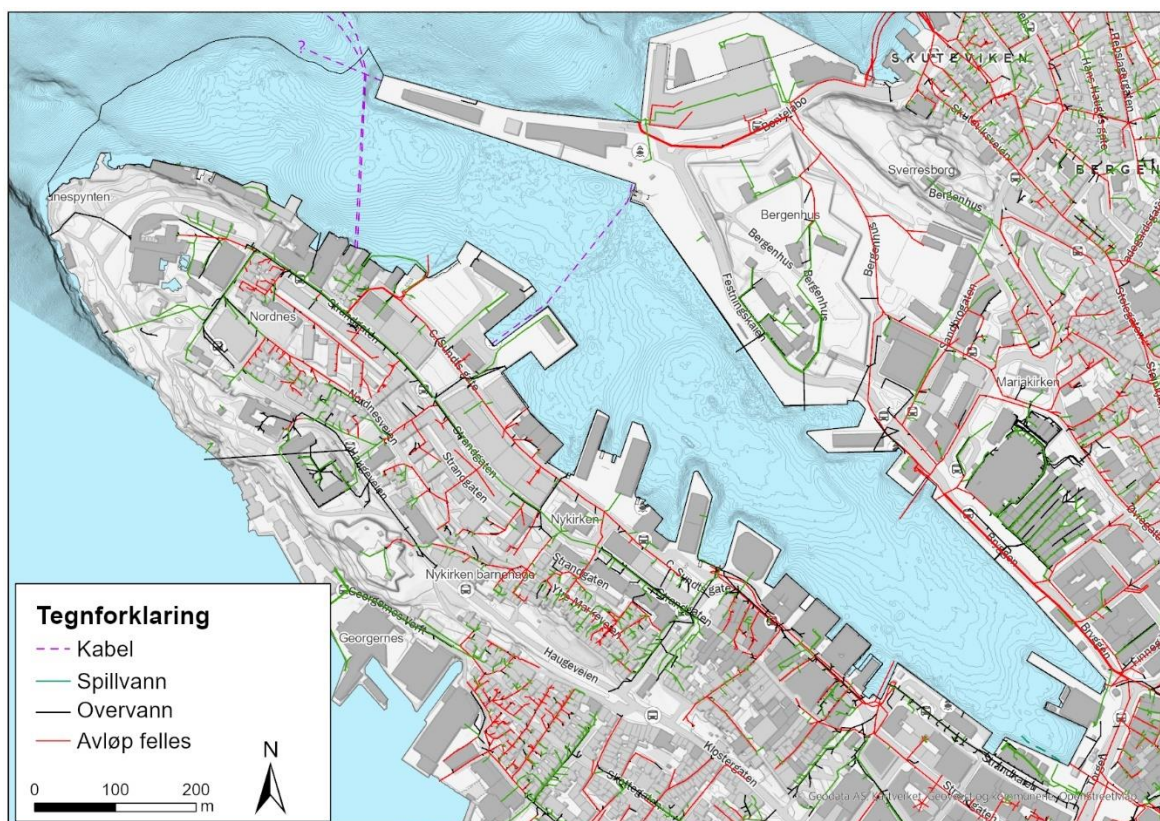
Figur 43 Oversikt over ledninger og kabler i tiltaksområdet. Ledningsdata er innhentet fra Bergen Vann 21.11.24. Den stiplede grønne linjen rett utenfor Torget er ikke inntegnet i VA-etatens datasett, men ledningen ble filmet med ROV 15.01.21.
