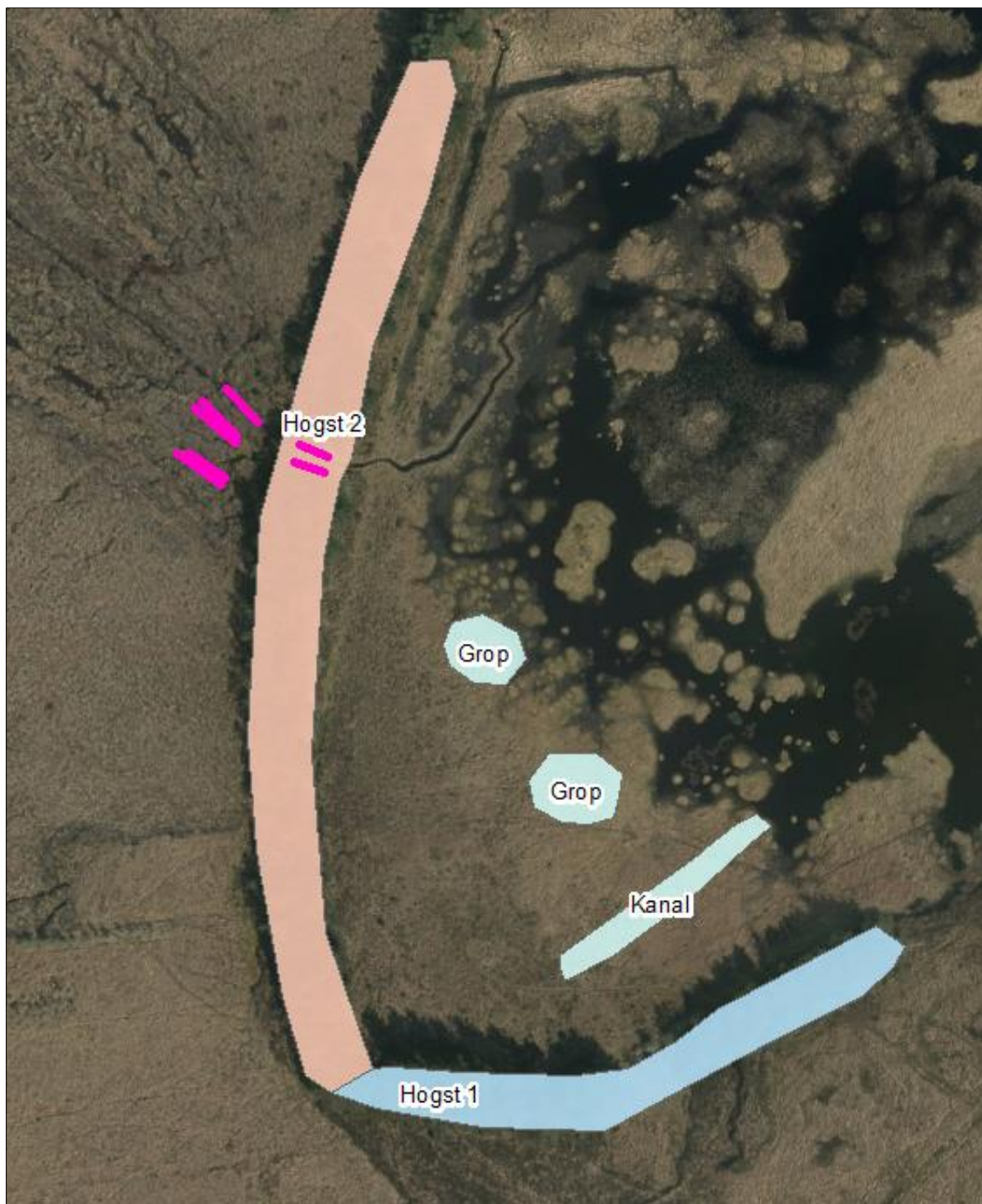
Figur 7. Utklipp fra arbeidsinstruks som viser planlagt håndtering av hogstavfall. I område Hogst 1, skulle avfall legges på innsiden av torvkant, kanten graves over og masser legges på fra utgravd kanal. I område for Hogst 2 var det også planlagt å legge hogstavfall på innsiden av torvkant, men i tillegg en del stokker i grøfter og forsenkninger på utsiden av kanten. Det var også planlagt en demning ved innløpet i vest. Røde linjer i vest viser mulig plassering av stokker. Masser til å legge oppå hogstavfall kunne eventuelt hentes fra groper nær vannspeilet. Plassering av både kanal og groper var veiledende, men ble i stor grad fulgt av gravemaskinfører.
