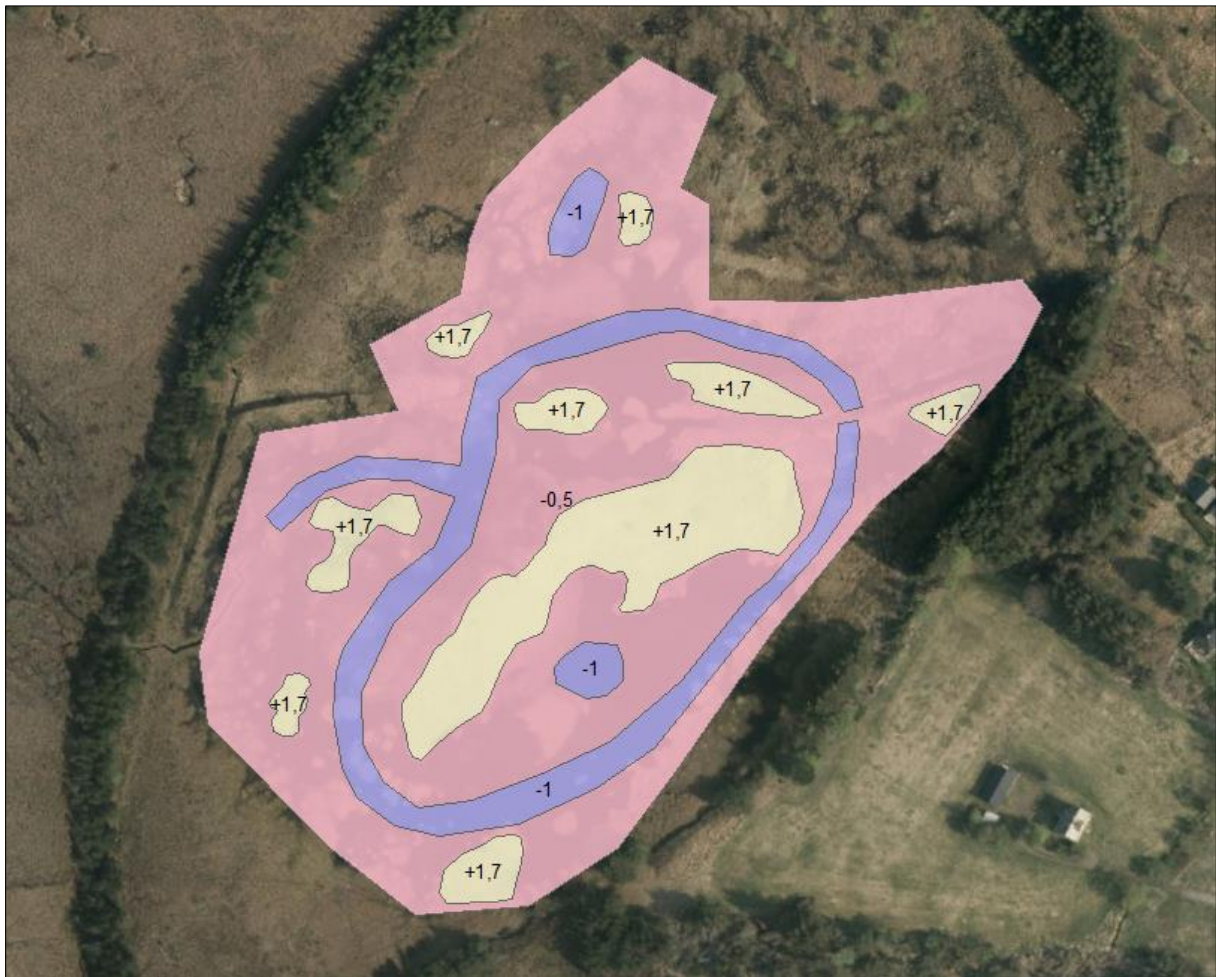
Figur 6. Utklipp fra arbeidsinstruks som viser at øyer var planlagt etablert med maks 1,7 meters høyde over fremtidig vannspeil. Masser skulle fjernes i hovedsak ned til - 0,5 meters dybde (rosa farge), men noen steder var det planlagt -1 meter (lilla).
