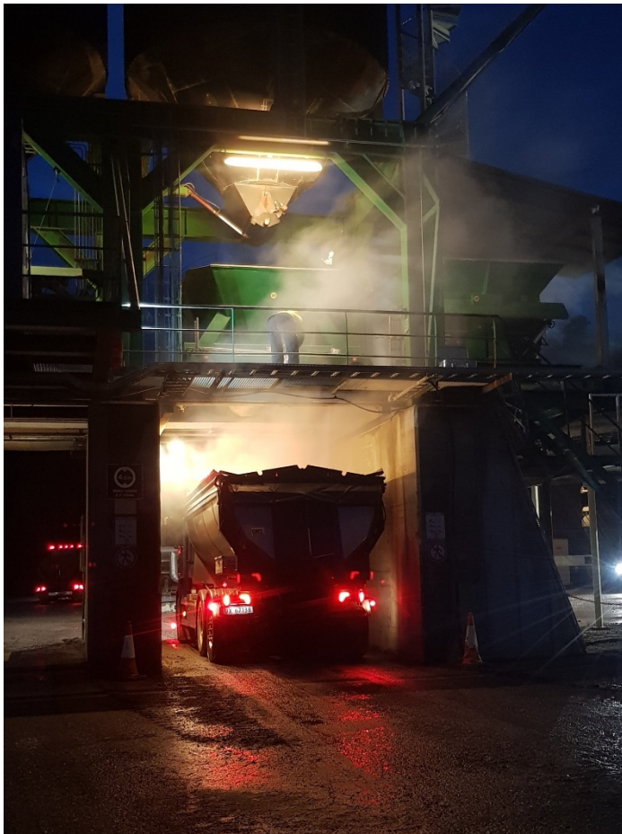
Figur 7. Prøvetaking ved tømning av asfalt.
