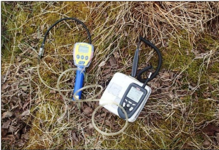
Figur 4 Måleutstyr for emisjon: fluksboks (isboks), sniffer med slange inn i boksen fra toppen, og CO 2 -måler med sonden inn gjennom hull på siden. (Bildet er fra et annet prosjekt)
