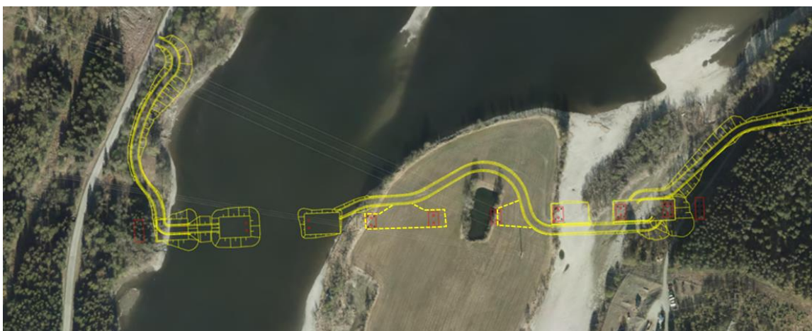
Figur 2-8. Illustrasjon av midlertidig atkomst og arbeidsområder i tilknytning til bruksene.
