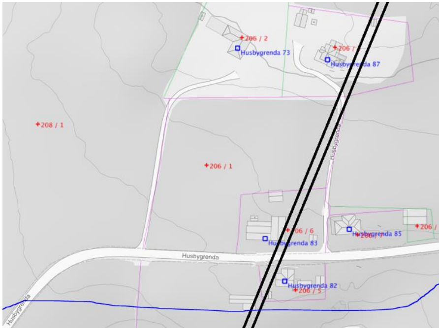
Figur 8: Ny privat vannledning tilknyttet Husbygrenda 87. Sort linje angir Åsentunnelen. Blå line angir kommunalt vannforsyningsnett.
