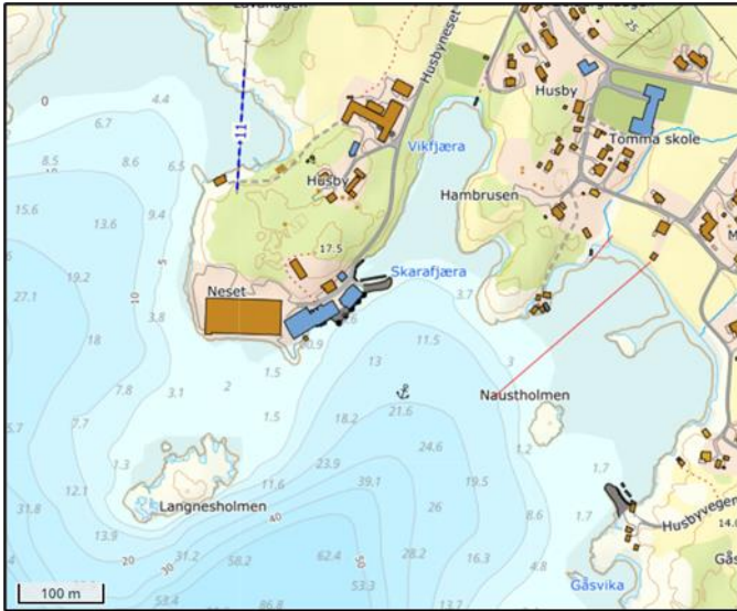
Figur 10. Utsnitt fra Kystinfo (7) som viser kartlag for marin infrastruktur, herunder undervannskabler, rørledninger, luftspenn med friseilingshøyde, broer med friseilingshøyde, havbruk med fortøyningskabler, vrak osv. Blå stiplet linje viser strømkabel, mens rød linje viser tilsynelatende utslippsrør.
