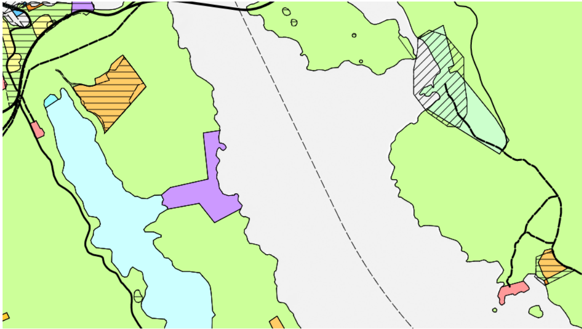
Figur 2-3 Aure kommune - arealplan, utsnitt av kart. Lilla område er industriområdet, grønt er LNFR, og oransje er bebyggelse, boliger og fritidsbebyggelse.
