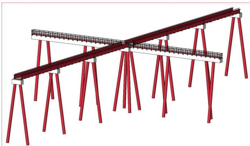
Figur 24: Utklipp fra beregningsmodell for gangbro
