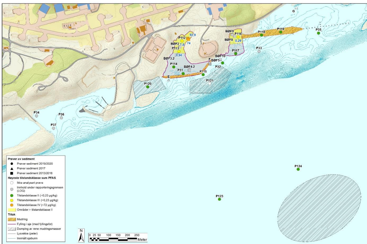
Figur 18: Tiltaksområde øst. Sedimentprøver klassifisert iht. påviste konsentrasjoner av sum PFAS (kun påviste konsentrasjoner er inkludert). Tilstandsklasser for PFOS er benyttet i klassifiseringen av sum PFAS. Sum PFAS er vist med blå skrift i punkter som er klassifisert som tilstandsklasse 3.
