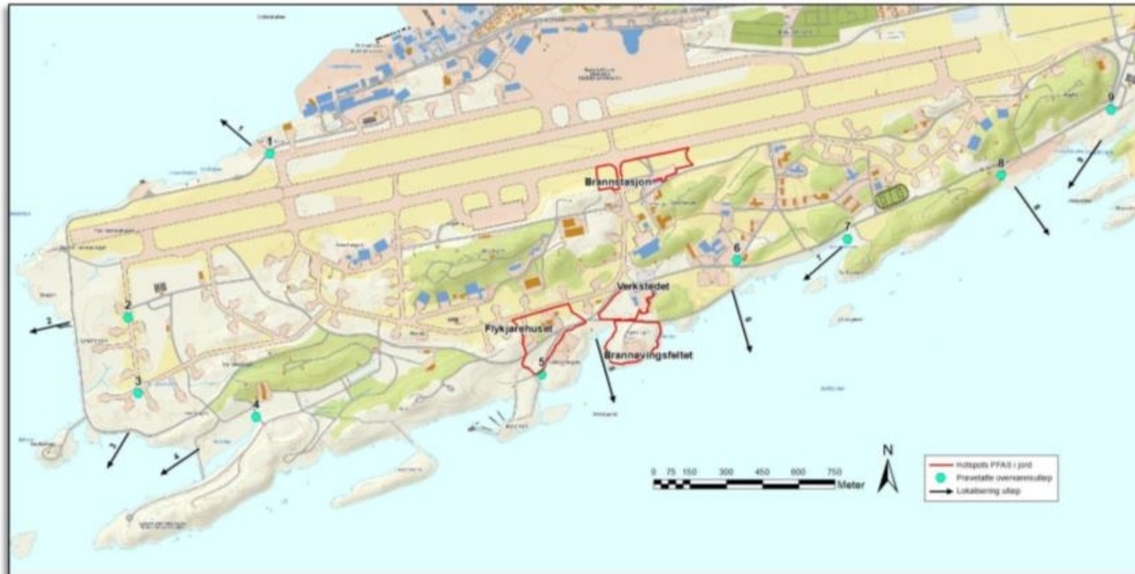
Figur 14: Områder hvor det er kartlagt høye konsentrasjoner av PFAS i grunnvann og overvannsutløp og kummer
