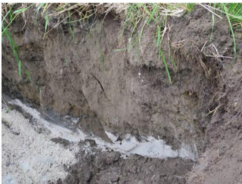
Figur B11: Prøvepunkt O3-5 sjakt (0 – 2,5 m). Grunnvann i skjellsand (antatt opprinnelig sjøbunn).
