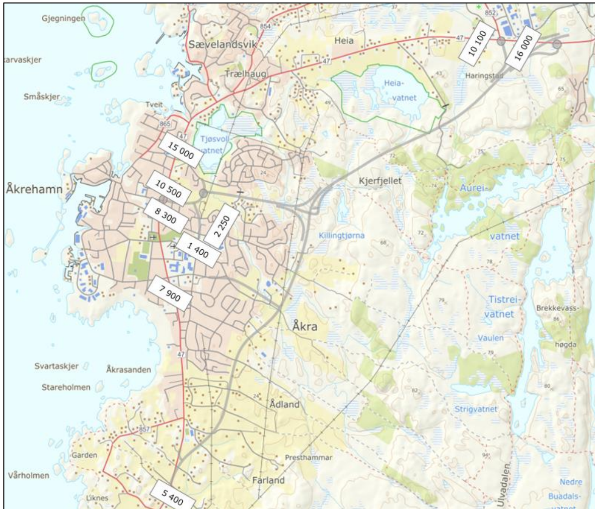
Figur 8: Trafikkmengder 2040 på dagens vegnett uten ny fv. 47. Planalternativ 1 er vist i grått.
