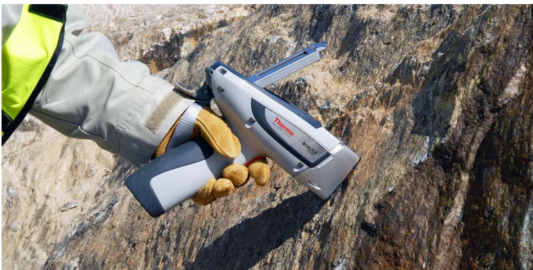
Figur 7 Bærbar XRF for bestemmelse av svovel og metaller i felt
