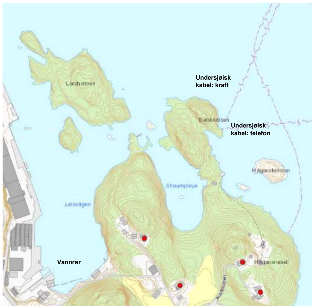
Figur 8 Oversikt over kabler i sjø [9].
