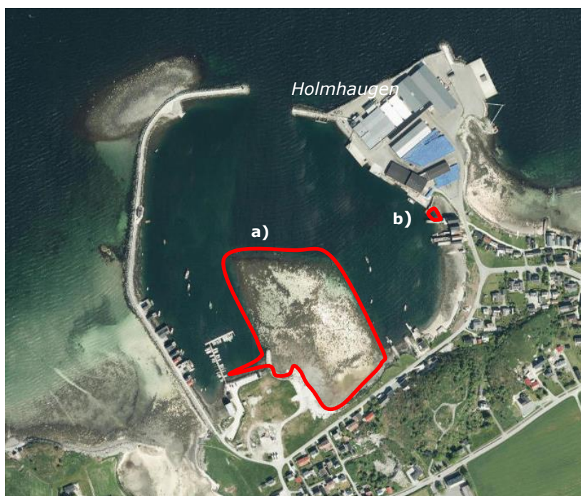
Figur 1. Kart over tiltaksområder. a) Tiltaksområdet i fjæresone i den sørlige delen av havnen, planlagt område for fylling er tegnet inn med rødt. b) Planlagt område for fylling sør for Holmhaugen er tegnet inn med rødt.
