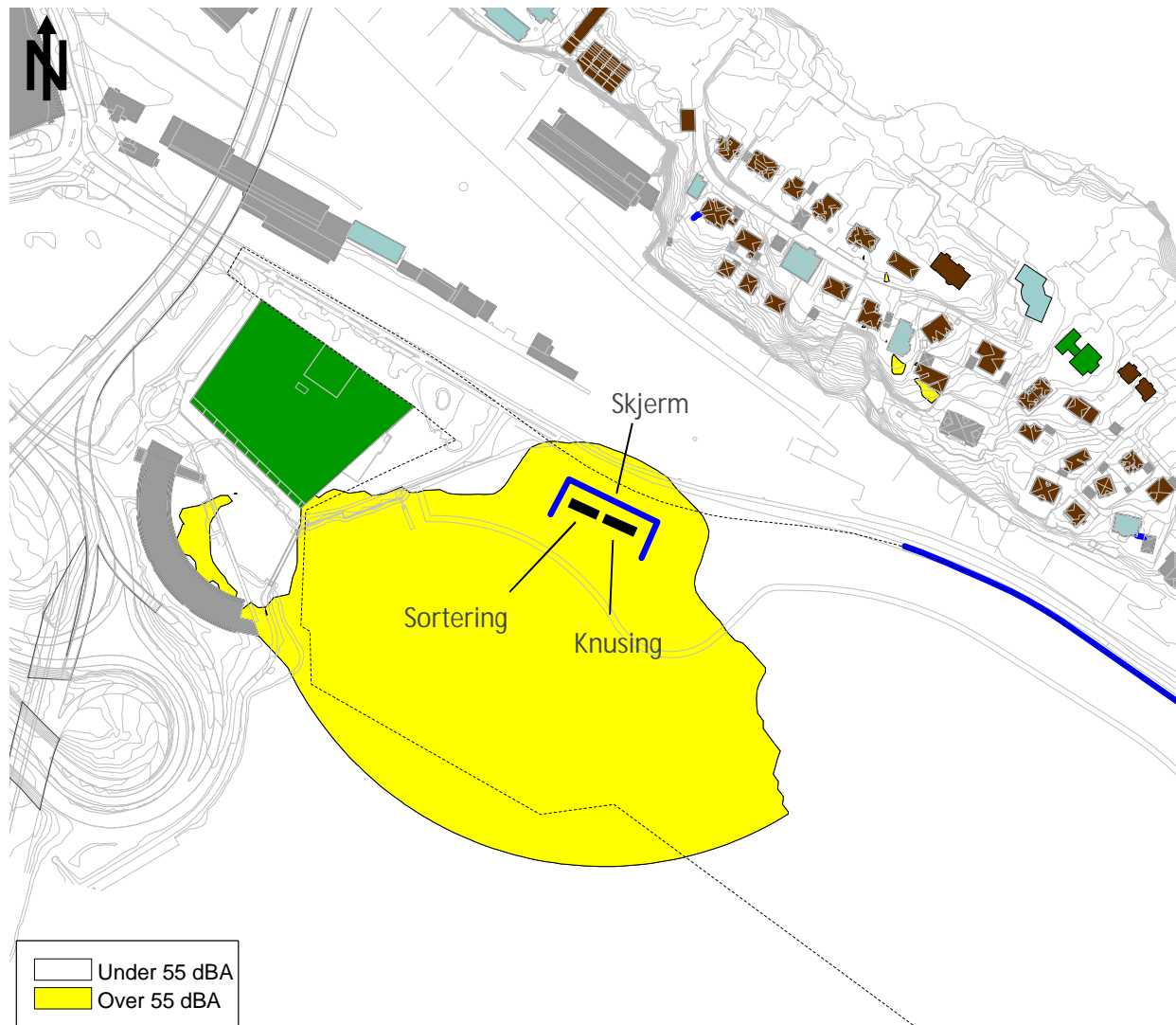
Figur 6. Støykart L_{den} dB for skjermet sortering og knusing med redusert samlet driftstid totalt 8 t.
