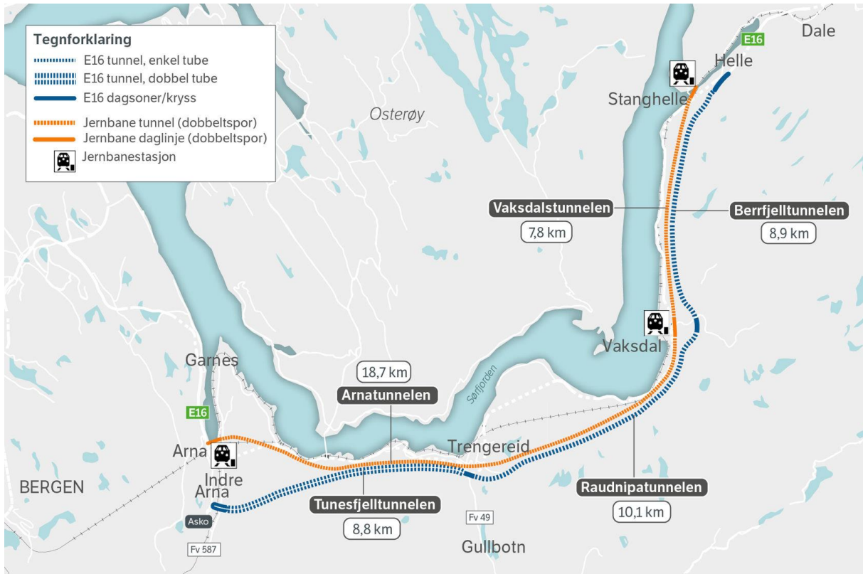
Figur 2-1: Jernbane- og vegtraseen som ble vedtatt i reguleringsplan for E16 og Vossebanen, Arna-Stanghelle (se kap. 2.2). Illustrasjon: Statens vegvesen.
