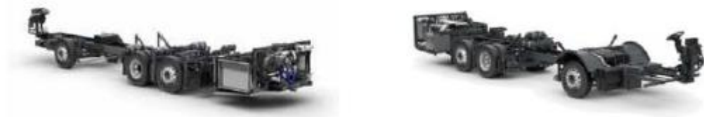
Figur 109. Illustrasjon, Volvos to chassis B8R og B11R 210
