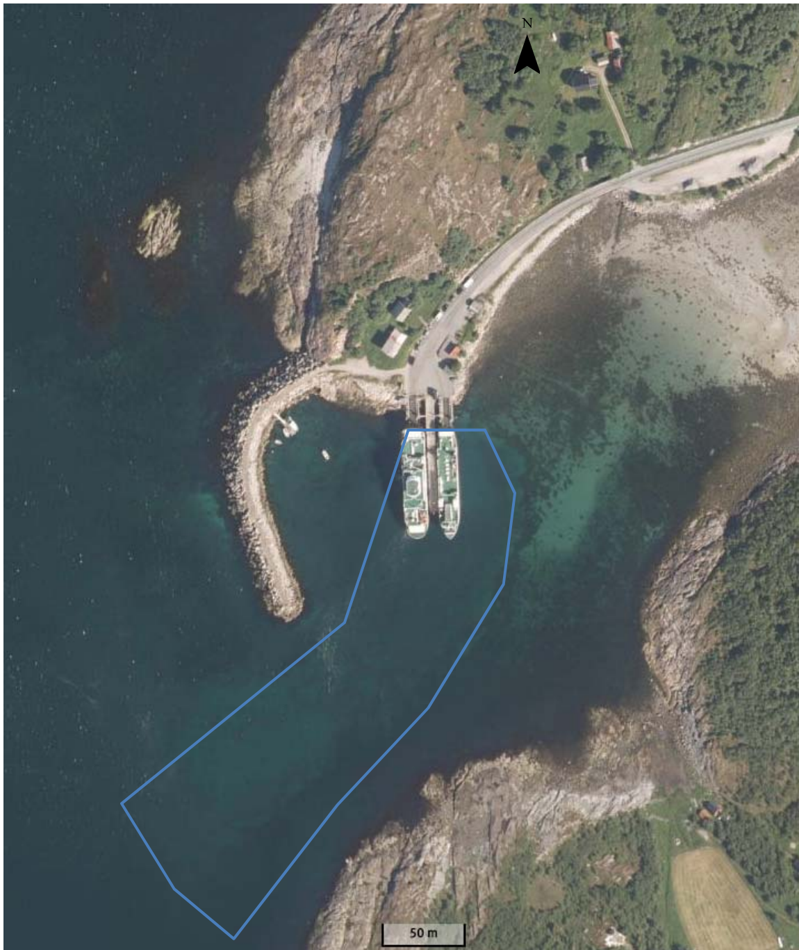
Figur 2: Flyfoto over Holm fergeleie. Området for planlagt utdyping er markert med blått.. Kartkilde: Norgeskart.no Areal av utdypingsområdet: Oppdragsgiver
