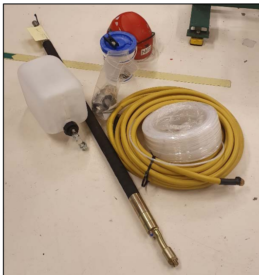
Figur 10 Packeren og trykkammeret benyttet for tilbakespyling av finstoff i filtersand rundt grunnvannsbrønner.
