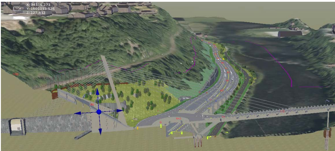
Figur 1 Oversiktsbilde av den nye brua over Nidelva, med forankringskammeret nederst til venstre i bildet.
