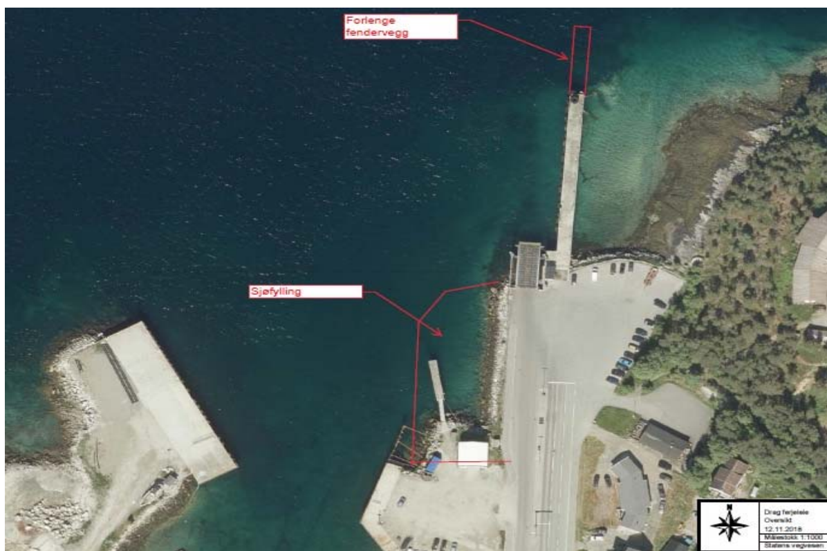
Figur 3: Oversikt over planlagt tiltak på sjø ved fergeleiet på Drag (kilde: Statens vegvesen).
