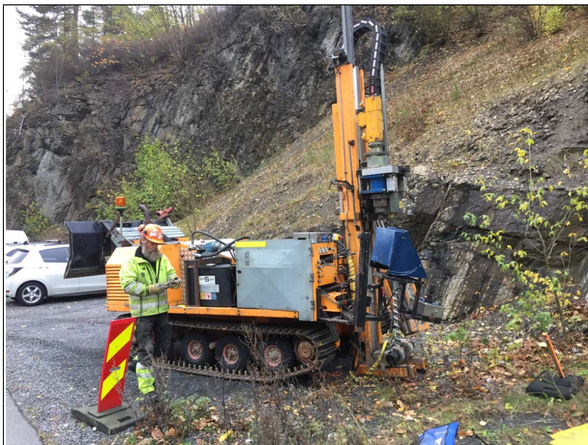
Figur 2 Boreriggen plassert ved borpunkt BES002. Det er fjell i dagen nord og øst i tiltaksområdet.
