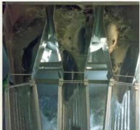
Bilder A.4 og A.5: Ensretting av fisk og bløggerobot
