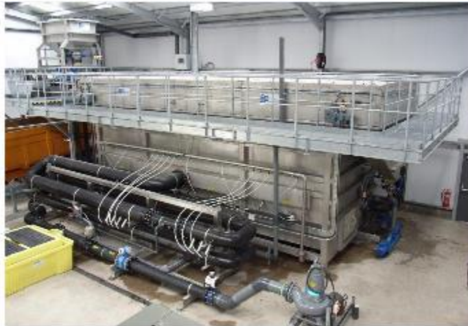
Bilde E3: eksempel flotasjonsenhet Nijhuis NPF.
