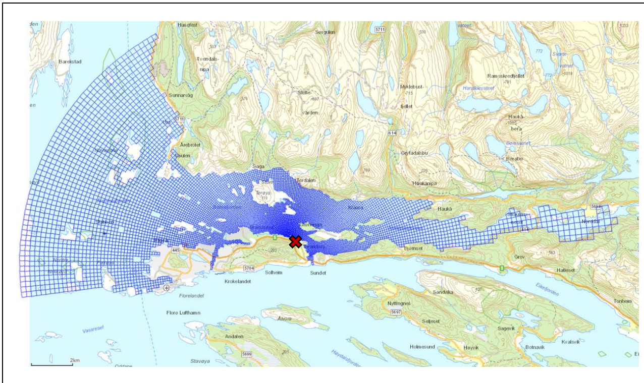
Figur 3.2 Rutenett benyttet for å modellere strøm og utslipp fra anlegget der anleggsposisjon vist med X . Kartet er hentet fra Fiskeridirektoratets kartverktøy. Kartdatum: WGS84.
