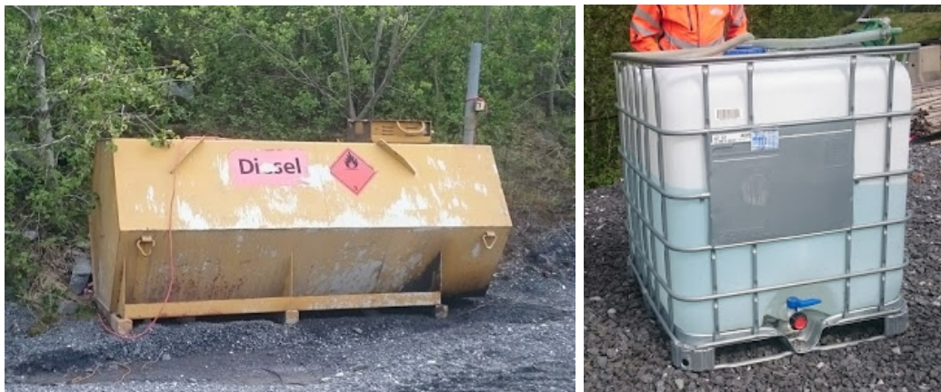
Bilde 3 Lagring av drivstoff og tilsetningsstoffet Ad Blue
