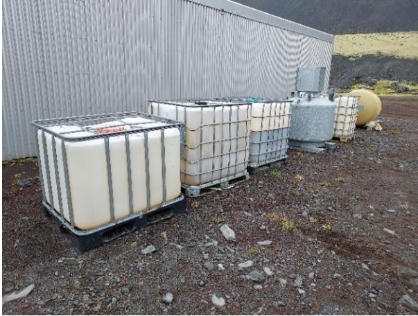
Fire usikrede IBC-kontainere ved stasjonen
