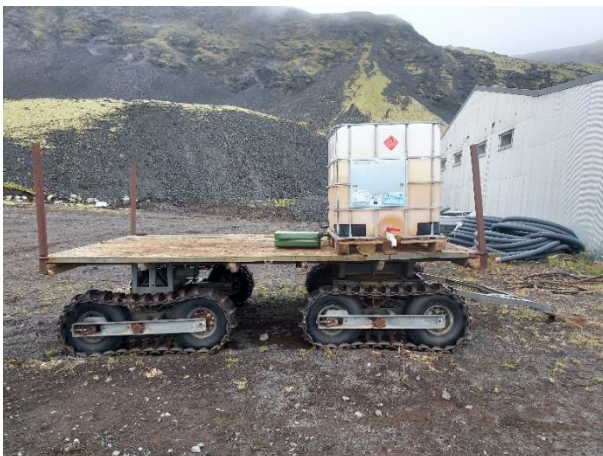
Usikret kontainer brukt som dagtank for diesel ved stasjonen
