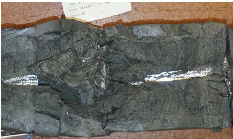
Figur 5: Bilde av sylindertestprøve fra 6,2-7 m dybde. Massene er silt som oppfører seg dilatant.
