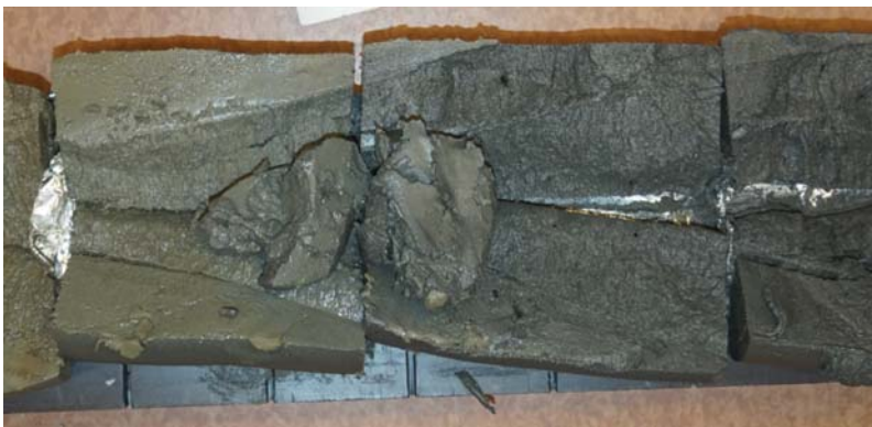
Figur 4: Bilde av sylindertestprøve fra 1,2-2 m dybde. Massene er silt som oppfører seg dilatant.
