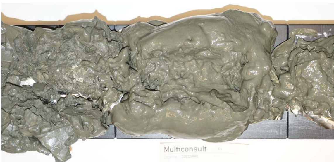
Figur 3-3 Løsmasser fra BP.13, 1,2-2,0 meter
