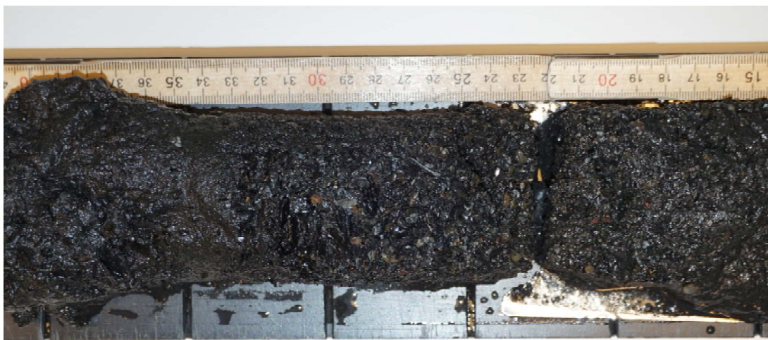
Figur 3-1 Løsmasser fra BP.8, 0,0-0,8 meter.
