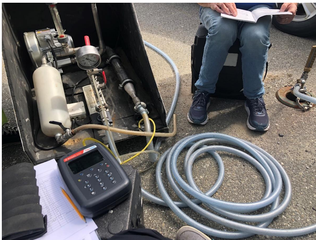
Figur 41 Bilder av pumpeutstyret og Biogass 5000 instrumentet som ble brukt under pumpeforsøket
