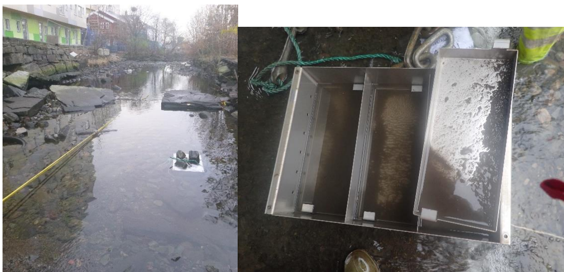
Figur 15 Bilder fra sedimentfellene som ble utplassert i Møllendalselven i perioden 26.10.18 – 18.01.19
