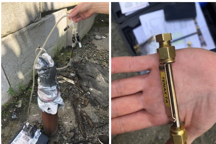
Figur 11 Prøvetakingsutstyr for VOC-screening i brønner. Venstre: Luft fra brønn J blir pumpet gjennom et ADT-rør. Høyre: Bilde av ADT-rør.
