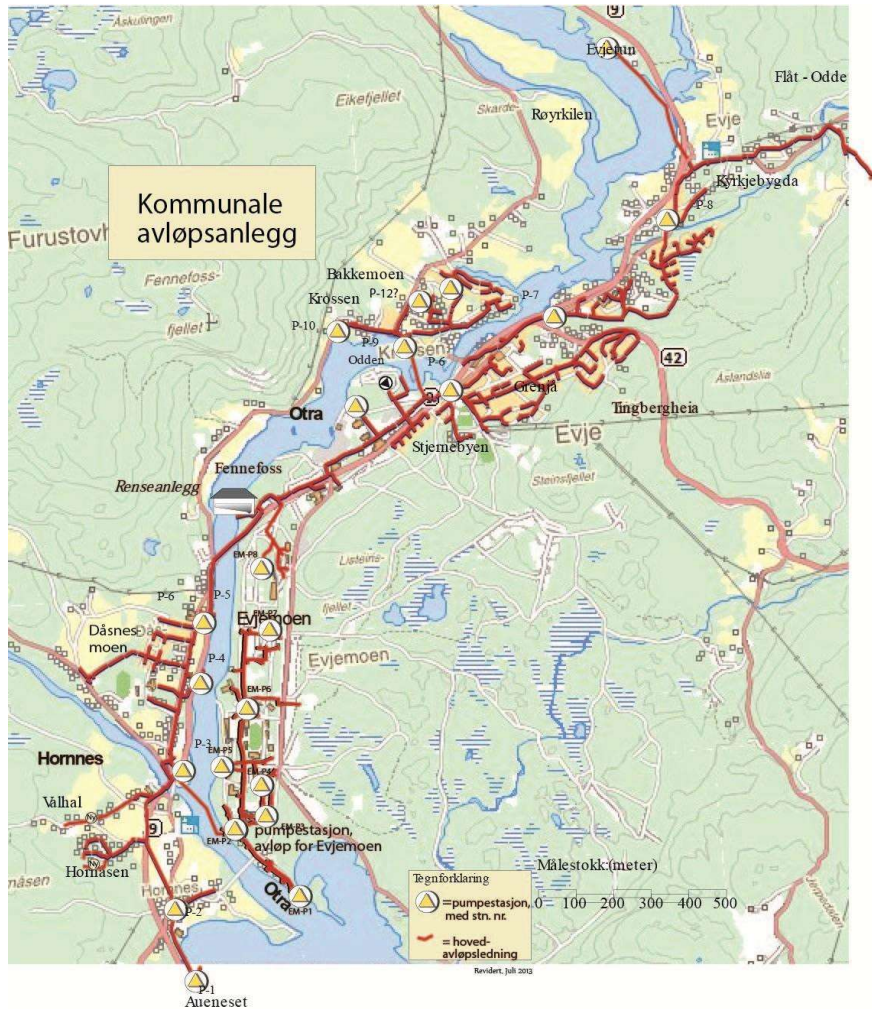
Figur 3. Oversiktsbilde over ledningsnettet tilknyttet Fennefoss. Bildet er hentet fra Hovedplan VA Evje 2008-2013. [1]
