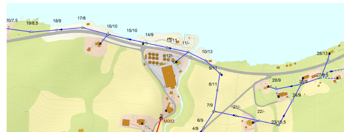
Figur 30: Viser eks. lavspentlinje og høgspenlinje i Haukвика. Heltrukket blå linje viser lavspent luftlinje. Heltrukket rød linje viser luftspenn høgspen.
