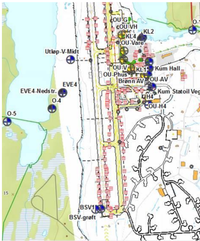
Figur 4 Sørlig del av lufthavna med overvannsnett. «Utløp» er rør/kummer som fører overvann fra avising. Punkt BSV og Utløp-V-Midt drenerer til bekk. Andre punkter representerer de eksisterende overvåkningspunktene. OV-4 er prøvepunktet i en bekk, som drenerer det nedlagte brannøvingsfeltet/PFAS (fjernes vinteren 2020/2021).
