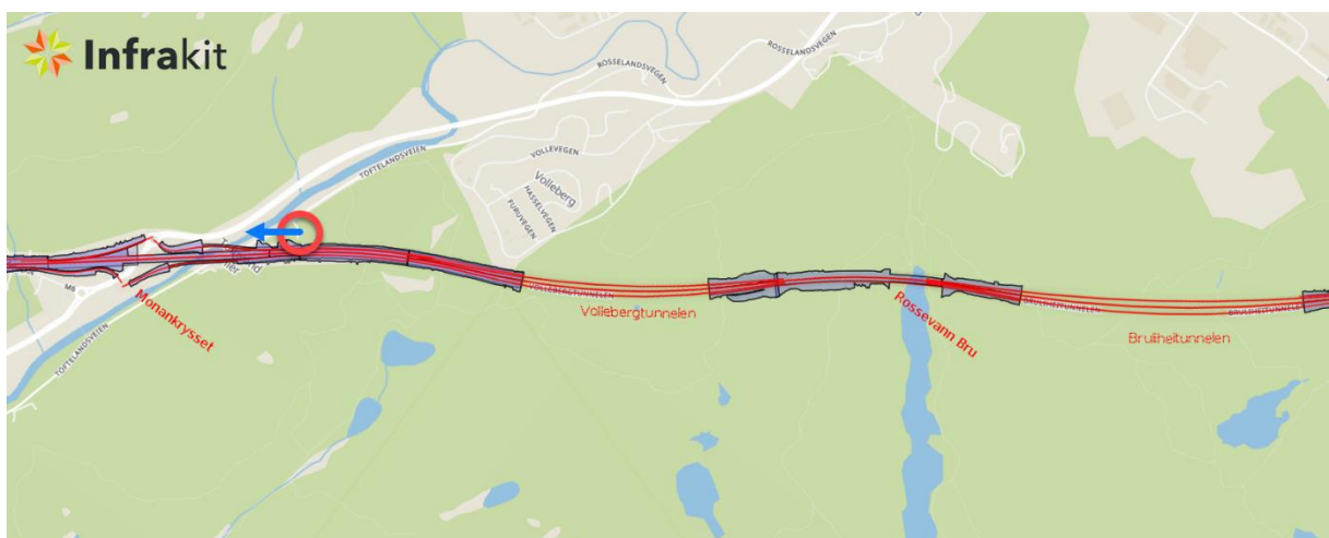
Figur 10: Vaskevannstank for tunnelvann fra Bruliheitunnelen og Vollebergtunnelen er indikert med rød sirkel. Avrenningsretning er vist med blå pil.
