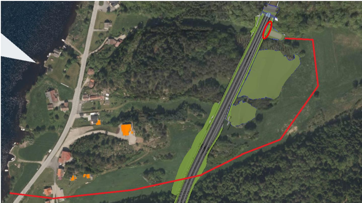
Figur 4. Vaskevann fra tunnelen samles opp i et lukket sedimentasjonsbasseng ved utsiden av søndre tunnelportal (plassering innenfor den røde sirkelen). Vannet føres videre inn i filterbasseng før det ledes til Mandalselva via eksisterende lukket overvannssystem.
