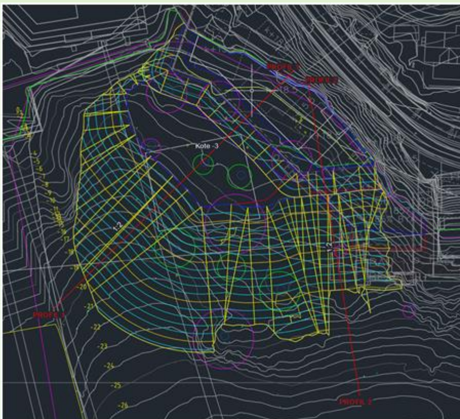
Figur 11 - Planskisse av oppbygning av fylling med profil 1 og 2 markert i tegningen, utarbeidet av geotekniker fra Multiconsult.
