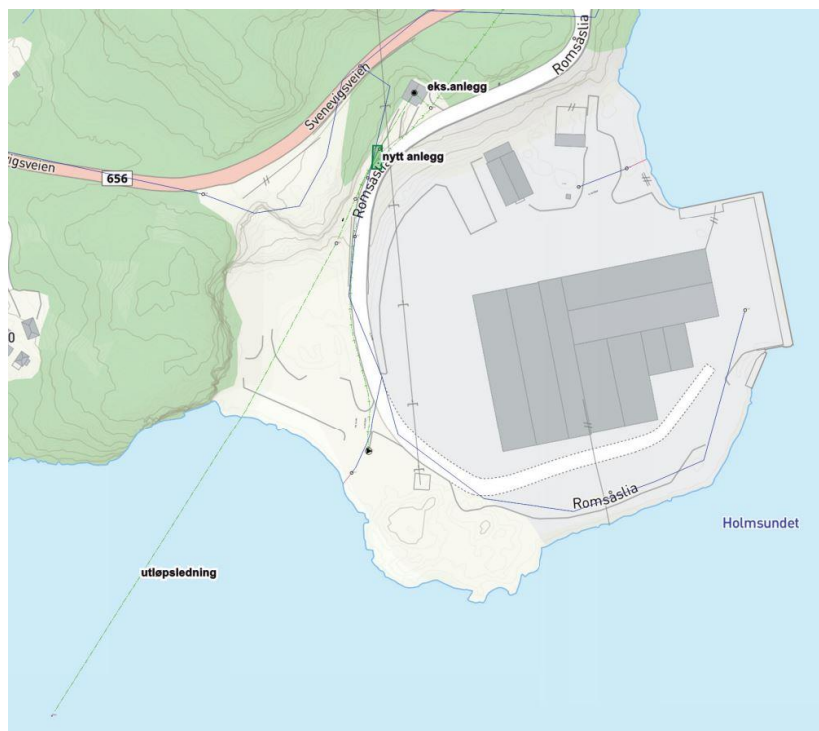
Figur 2 Plassering av utløpsledning fra reanseanlegget, dybde 40 m.
