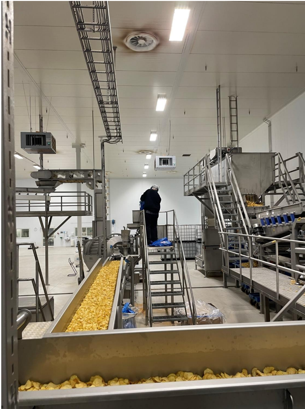
Figur 10. Transportlinje hvor ferdig chips tilsettes krydder.
