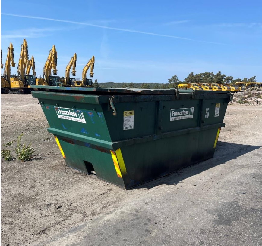
Figur 26. Lukket container med avfall/slam fra bunnen av frityr. På grunn av høyt innhold av olje, leveres avfallet som farlig avfall.
