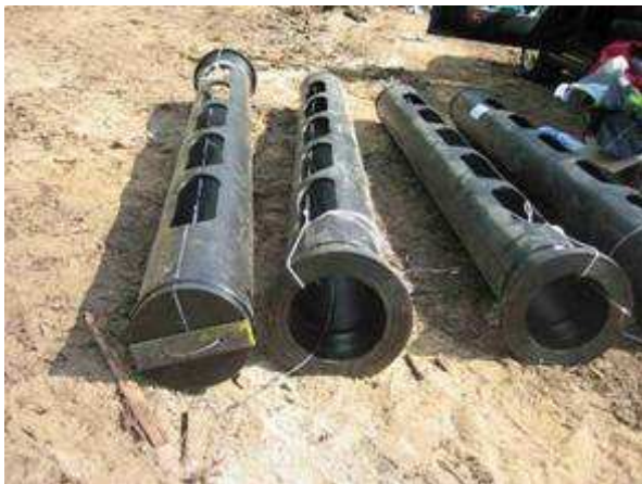
Figur 1. Prøvetakingsrør – Plassering av parasitteggposer og temperaturloggere.
