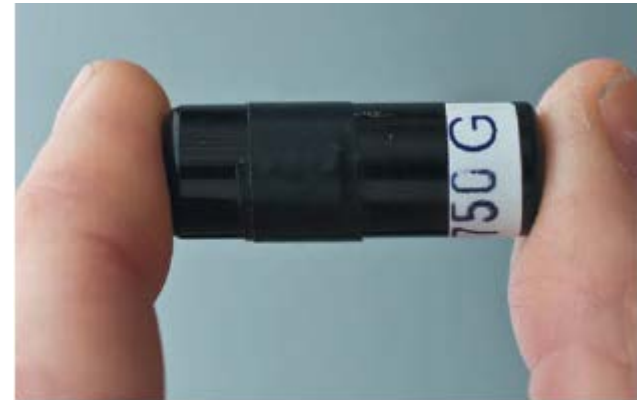
Data Storage Tag – opereres inn i fiskens bukule og «logger» kontinuerlig data om dybde og vanntemperatur i opptil 2 år.
