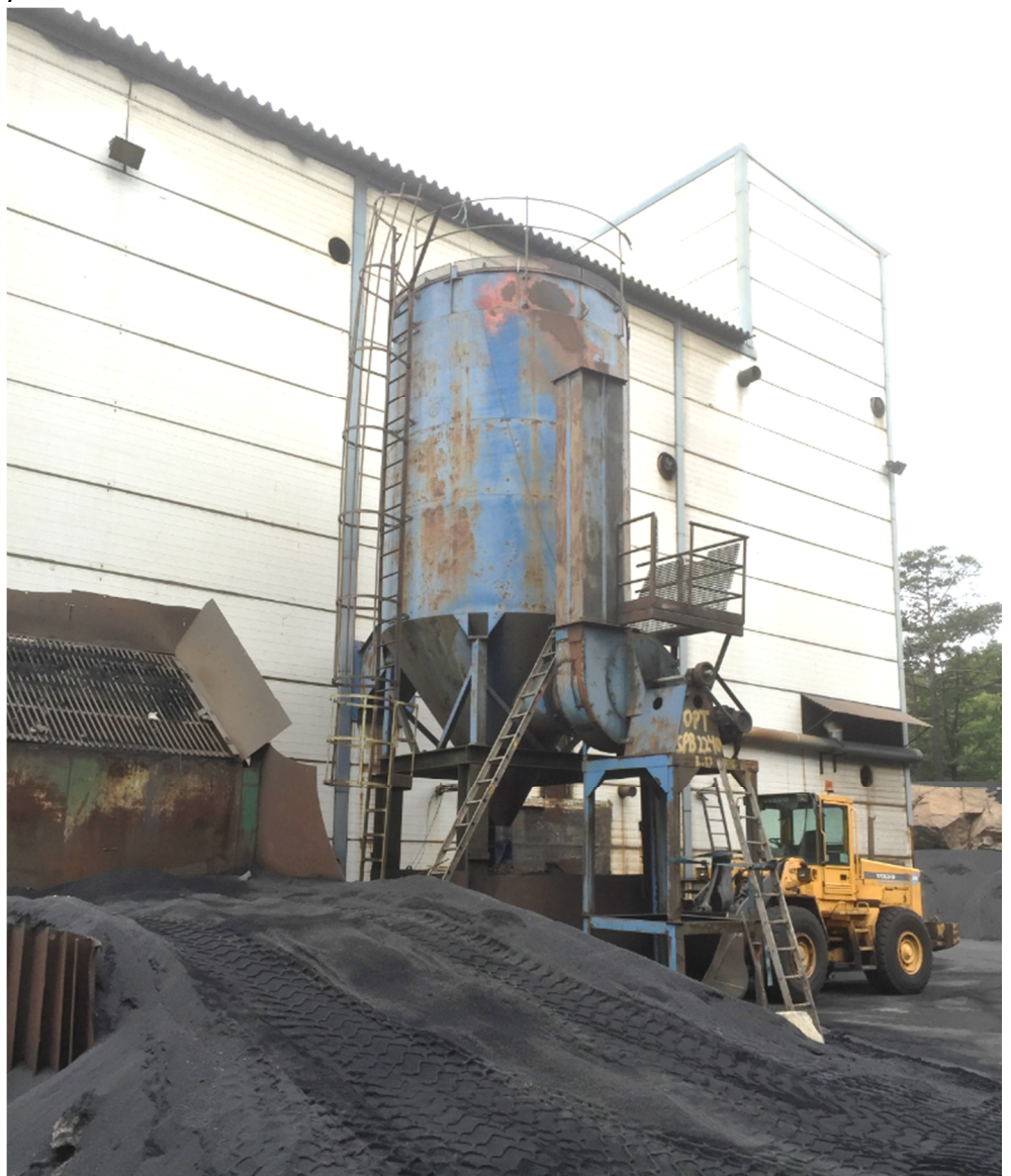
Figur 4: Bildet viser innkjøringsrampe og rist for råstoff og utvendig filteranlegg. Filteranlegget ble tidligere brukt til å samle støv fra knuse- og sikteanlegg, og brukes fra oktober 2016 til å samle støv ifra tørke mens støvet fra knuse- og sikteanlegget nå samles opp i et nytt filteranlegg. Ref. figur 6.
