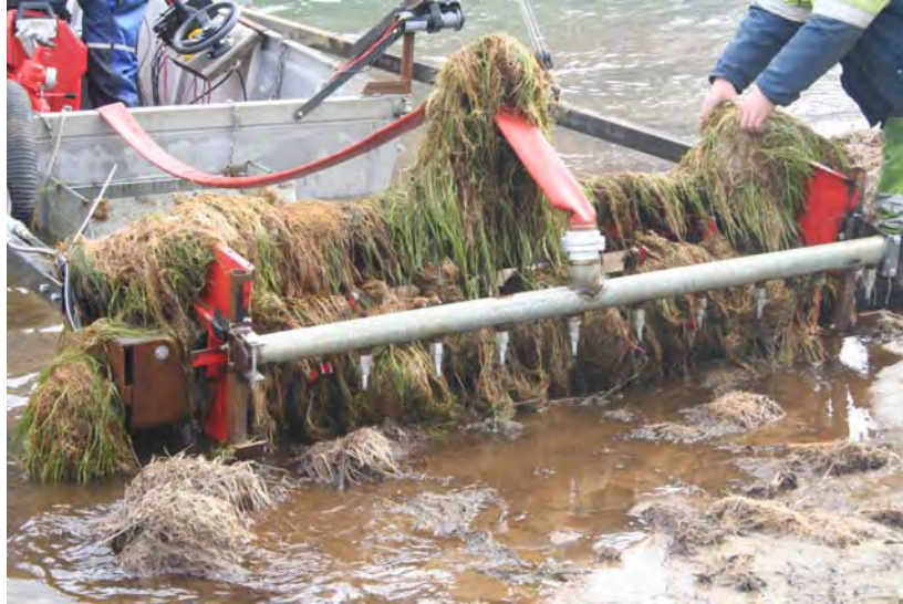
Utstyr for å frese og spyle krypsiv og bunn-sedimenter. Fresen er full av krypsiv. Foto: Tom Arild Homme.
