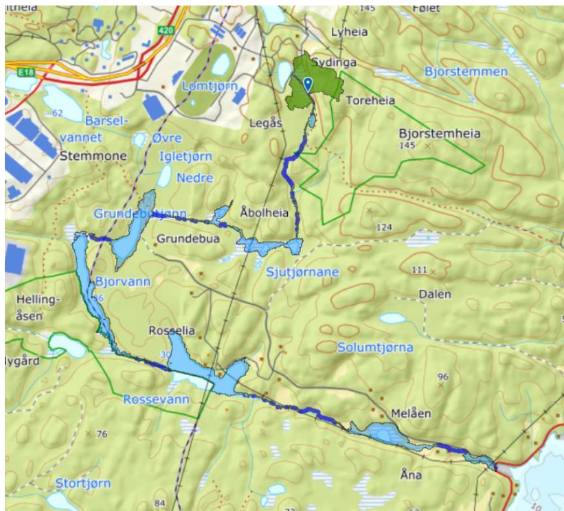
Figur 8 Flomvei til nedslagsfelt 2 (kilde: Scalgo)
