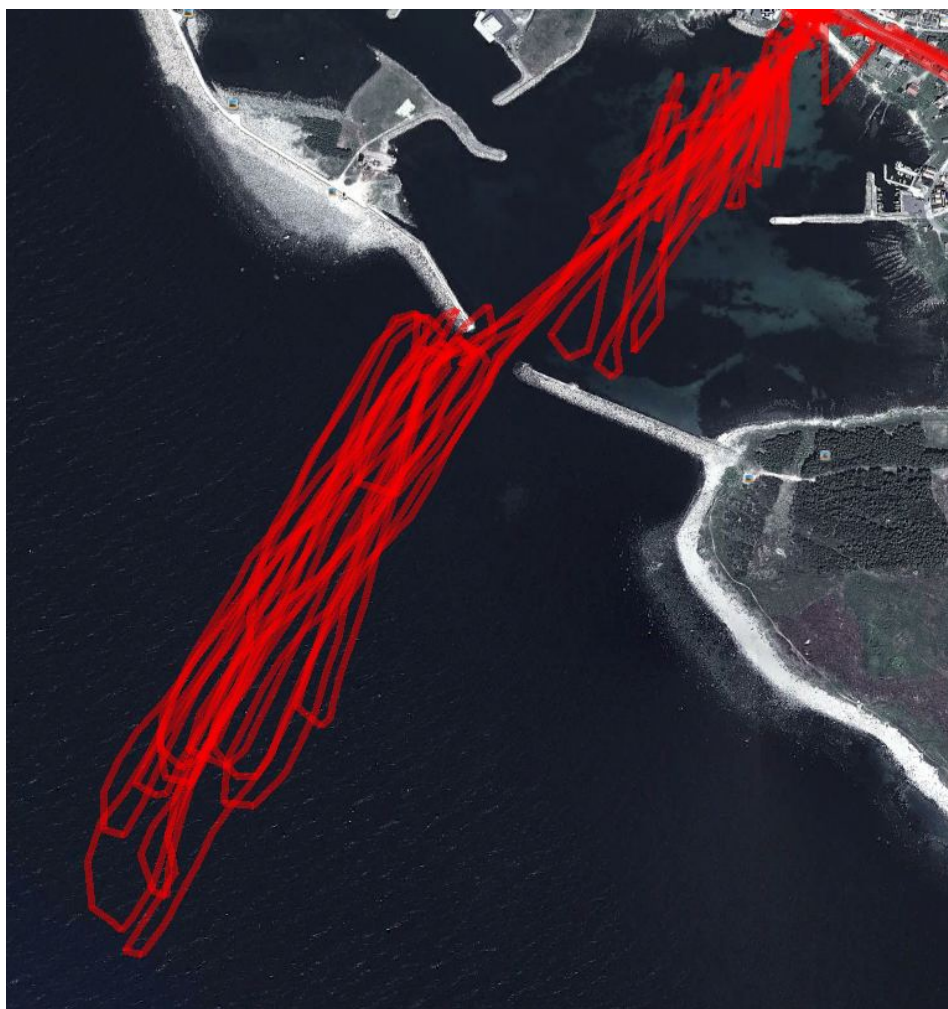
Figur 3.5. GPS-ruta for dei same to brettseglarane (båe med trackstick), den same dagen 6. april 2013. Dei gjekk ut frå «Bispen» inst i Tjørvebukta, og av og til ut gjennom opninga i moloen og segla utanfor ei stund. Vi ser at det er eit ganske høgt presisjonsnivå på GPS-registreringa, i høve til satellitt-fotoet (sjølv om det ser ut som at dei segla i moloen; det gjorde dei altså ikkje). Sjå også bilete på framsida av rapporten.
