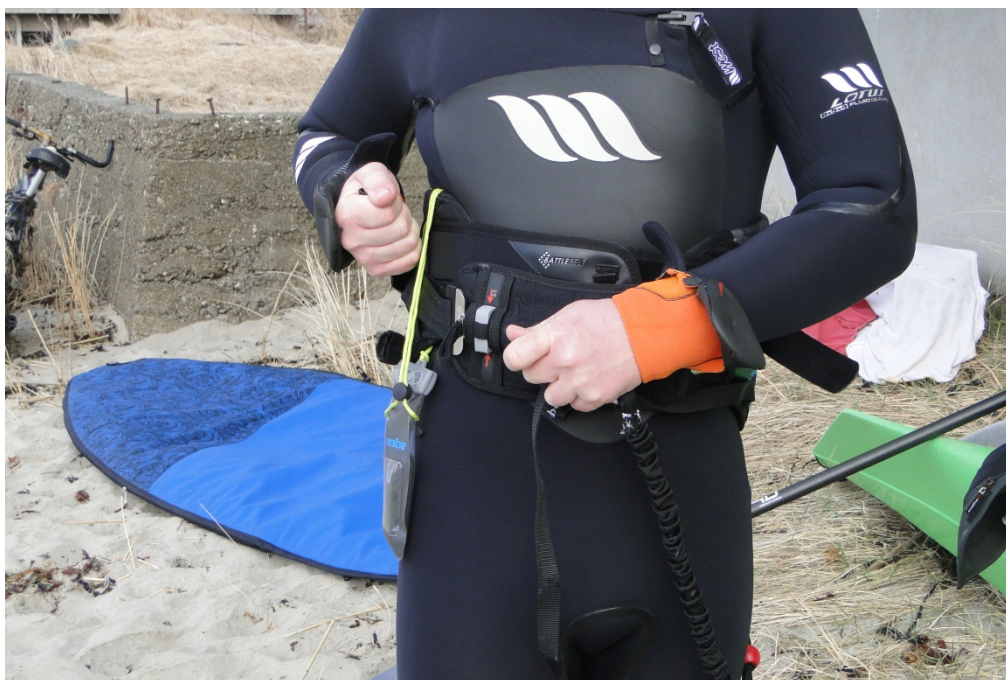
Figur 2.2 Trackstick i vasstett futteral som er hengt med snor i trapesen.
