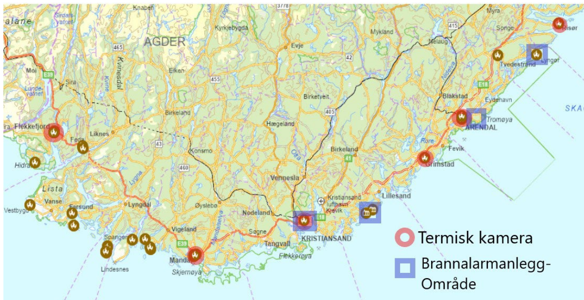
Figur 7: Oversikt over særskilt overvåking av trehusbebyggelse i kystbyene i Agder.
