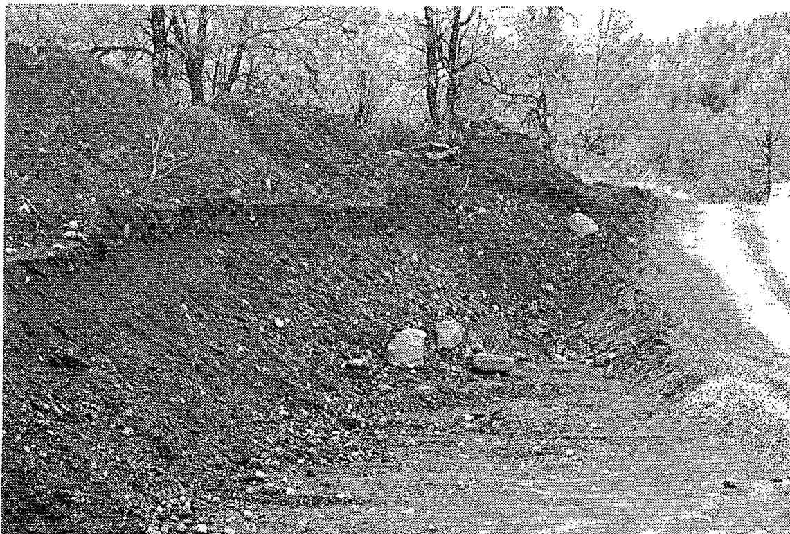
Fig. 12. Snitt i grusmassene sør for Butjørna. Forekomsten anbefales som stamgrustak for veivedlikeholdsområdet.
