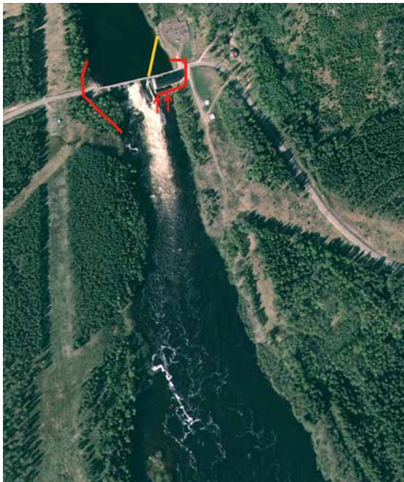
Figur 8. Prinsipp-skisse som viser forslag til plassering av to fisketrapp (røde linjer) og fiskeavleder (gul linje) ved Skoga kraftstasjon.
