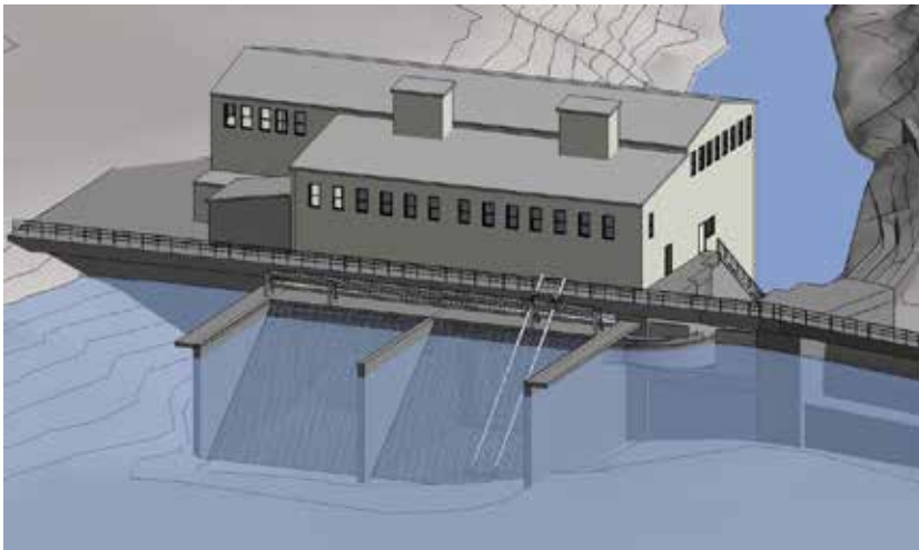
Figur 3. Principutformning av \alpha -galler för Edsforsens kraftverk. Illustration: Lind et al. (2014).
