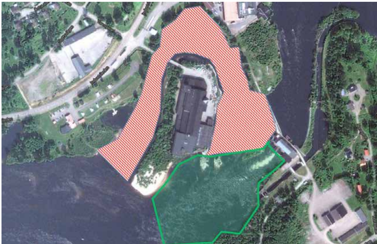
Figur 2. Prinsipp-skisse over tiltak som forbedrer oppvandringsforholdene ved Forshaga kraftstasjon. Elektrisk fiskesperre skal forhindre fisk fra å benytte sideløpet rundt øya (skravert rødt-hvitt), og på den måten øke andelen fisk som oppholder seg i hovedløpet som leder inn til fiskeinngangene i fisketrappa.
