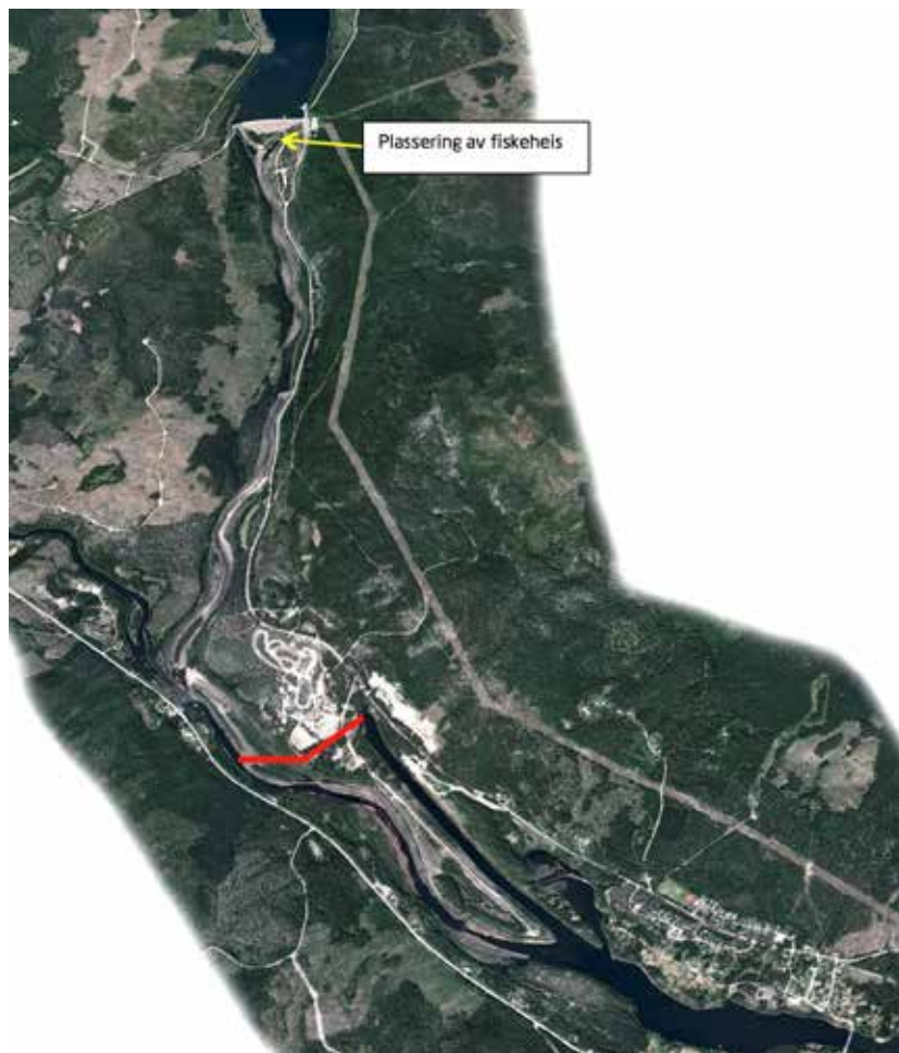
Figur 11. Oversikt over Höljes kraftverk og tilhørende vannveier. Forslag til plassering av fiskepassasje fra tunellutløpet og over til regulert elvestrekning nedenfor samløpet med Höljån (rød linje og fiskeheis ved damfoten (gul pil)).
