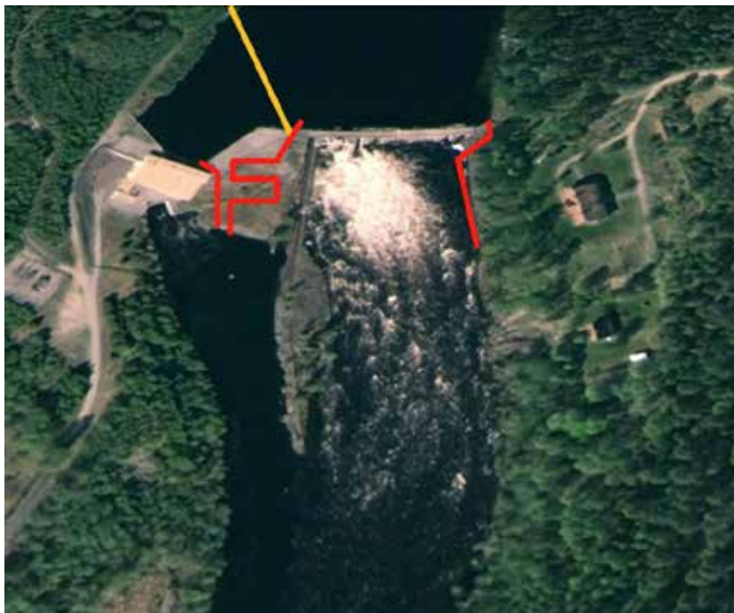
Figur 7. Prinsipp-skisse som viser foreslått plassering av to fisketrapper og en nedstrøms passasje (røde linjer) og fiskeavleder (gul linje) ved Krakeruds kraftverk.
