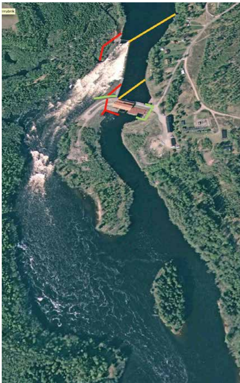
Figur 6. Prinsipp-skisse som viser foreslått plassering av to nye fisketrapper (røde linjer), fiskeavledere (gule linjer) og nedstrømpassasjer ved Forshult kraftstasjon (grønn linje).
