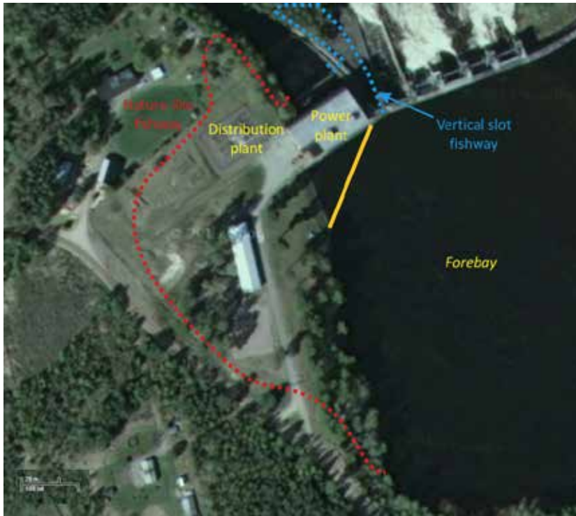
Figur 9. Prinsippskisse som viser forslag til plassering av to oppstrøms fiskepassasjer (rød og blå stiplede linje) og fiskeavleder (gul linje) ved Edsforsen kraftverk.
