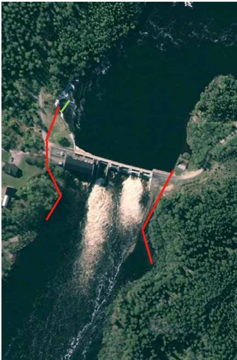
Figur 5. Prinsipp-skisse over lokaliseringene av to fisketrapper (røde linjer) og betongmur (grønn linje) for å skape rolige forhold ved vanninntaket ved Skymnäs kraftstasjon.
