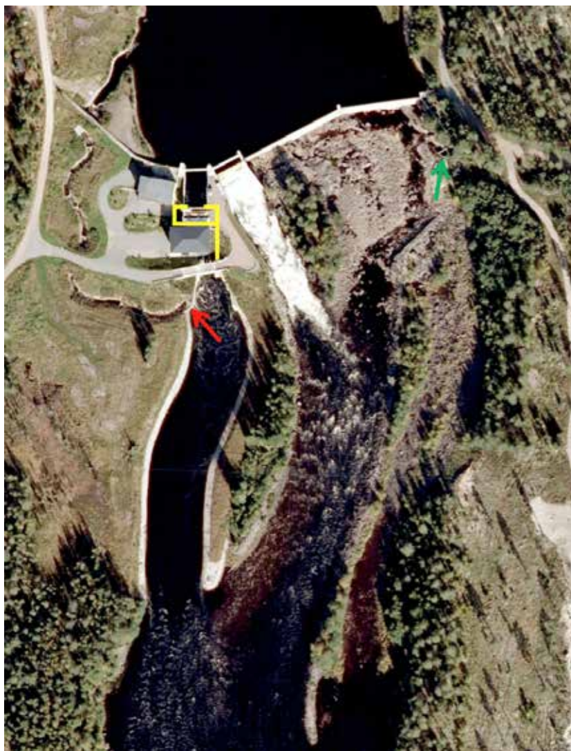
Figur 13. Prinsipp-skisse over Sagnfossen kraftverk og tilhørende vannveier. Forslag til plassering av to nedvandringspassasjer ved turbininntaket er vist med gule linjer, Forslag til ekstra fiskeinngang til fisketrappa ved turbinutslaget er markert med rød pil, mens den gamle kulpetrappa er markert med grønn pil. Se tekst for nærmere forklaringer.
