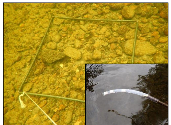
Figur 2: Kvadratisk metallramme på 50 x 50 cm og plastslange med diameter 13 mm som benyttes ved skjulmålinger.
