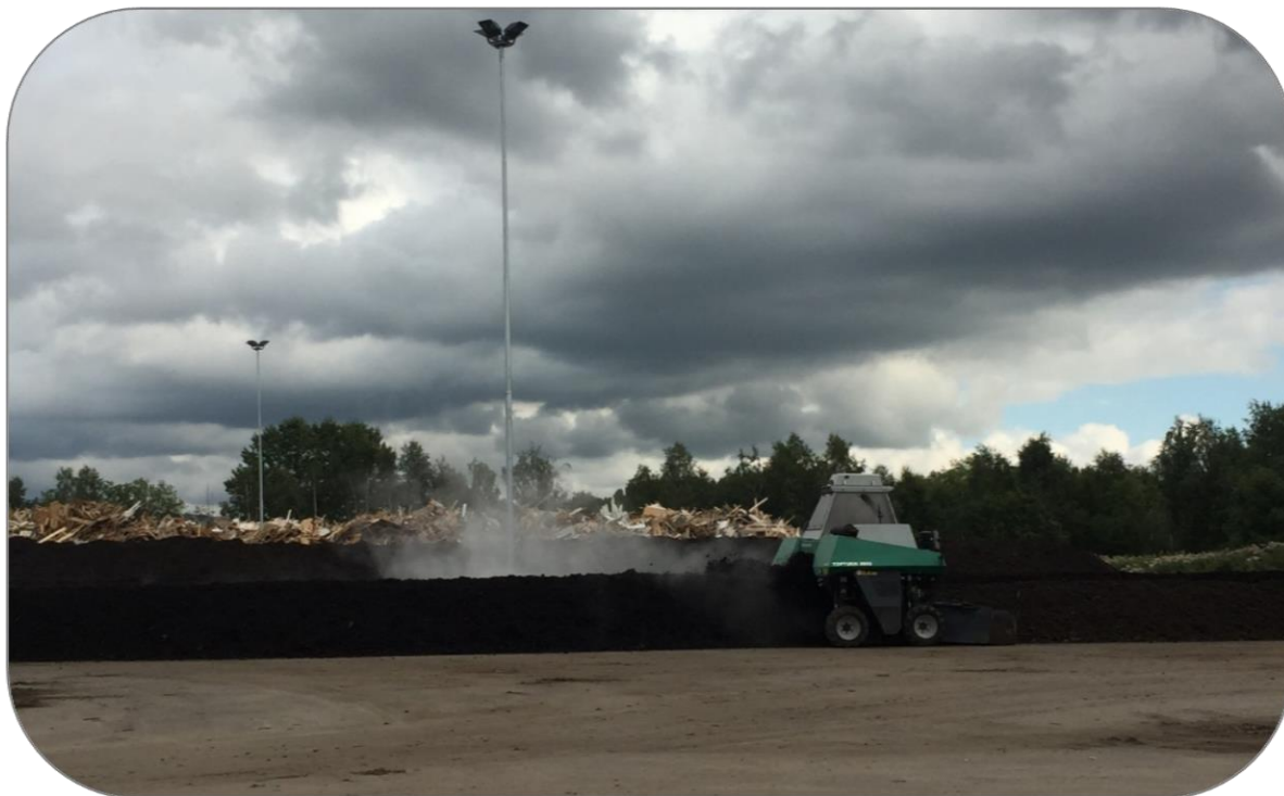
Figur 12. Sirkula på Hamar benytter vendemaskin for å vende massene.
