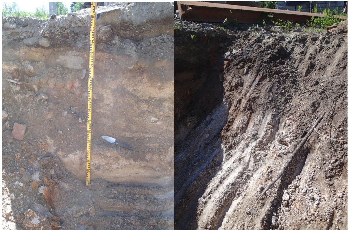
Figur 5. Sjakt EID06 – bilde til venstre viser lagdelingen i sjakta. Bilde til høyre viser nordvest siden av sjakta. Her ble det ble påtruffet et tykt lag med cellulosemasser. Alle massene i sjakta utgjør fyllmasser. For nærmere beskrivelse av massene i sjakt EID06 henvises det til tabell 4.
