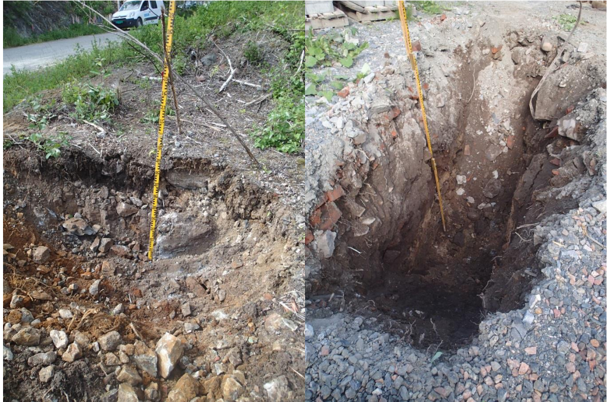
Figur 6. Bilde til venstre viser løsmasseprofilen i sjakt EID01. Bilde til høyre viser de antropogene lømassene sjakt EID05 sett oven i fra. For nærmere beskrivelse av massene i de to sjaktene henvises det til tabell 4.
