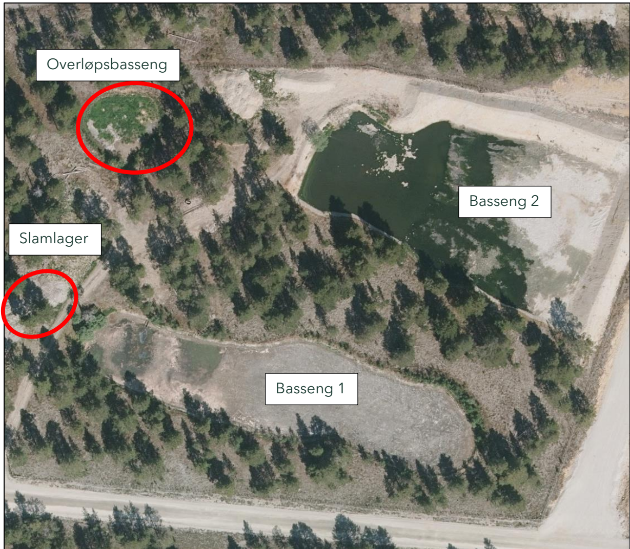
Figur 20: Flybilde av Bjorli renseanlegg, med to infiltrasjonsbassenger og ett overløpsbasseng. Målestokk 1:625.
